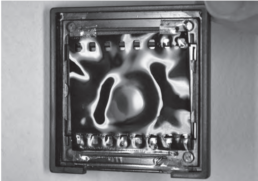
Abb. 10: Starke Erwärmung im Projektor hat bei diesem Dia zu irreversiblen Verwerfungen geführt. (Foto: Anna Ventura)
