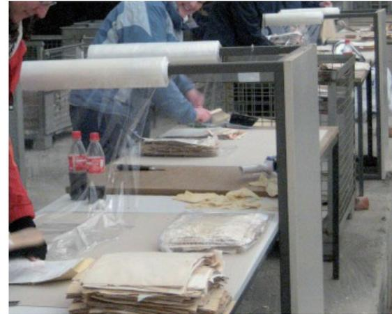
Improvisierte Abroller aus Tischbeinen oder Stangen/ Besenstiele. Beim Abrollen der Folie entsteht eine starke Zugbelastung; die Halterung muss vor Umstürzen in Zugrichtung gesichert sein.
